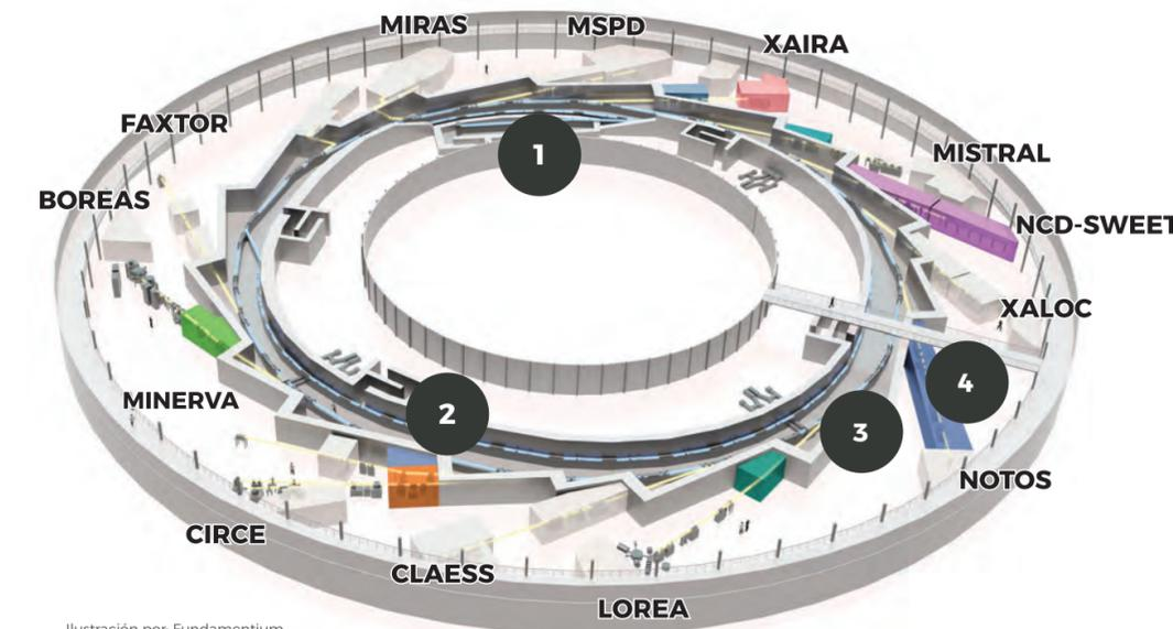
**2 Anillo propulsor:** después los electrones se aceleran aún más, esta vez ya en una trayectoria circular, hasta llevarlos casi a la velocidad de la luz.
